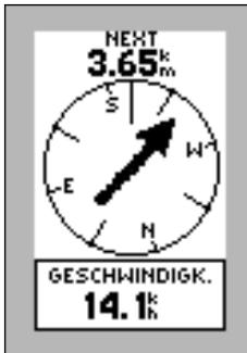
Oben im Display wird die Entfernung zum Ziel bzw. zum nächsten Wegpunkt angezeigt. Unten finden Sie ein Feld mit weiteren selbstwählbaren Informationen, in unserem Beispiel die aktuelle Geschwindigkeit.
